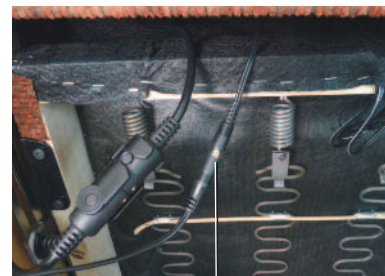
Connexion du transformateur électrique
