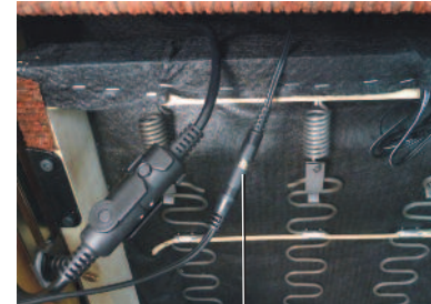
Conexión del transformador
