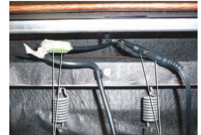
Conectores de la varilla manual Conectores del transformador de energía para masaje y calor
