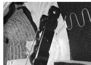
Palanca de inmovilización en posición trabada
