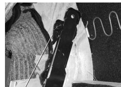
Levier de blocage en position « bloqué »
