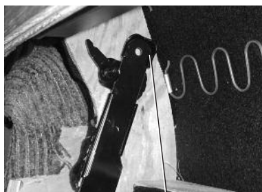
Ménsulas de soporte del respaldo y del cuerpo acopladas
